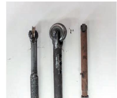
**REPUJADO:** Herramientas usadas para rebajar las piezas en el torno.
