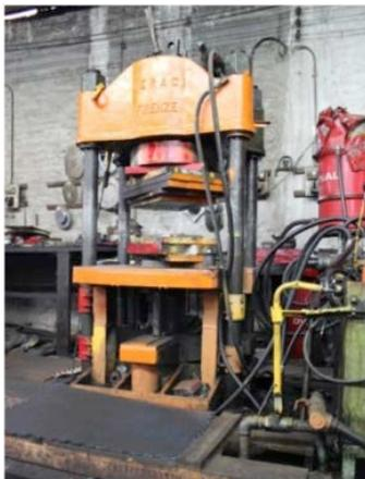
**ESTAMPACIÓN:** Prensa hidráulica empleada para estampar los moldes sobre las láminas de metal.
