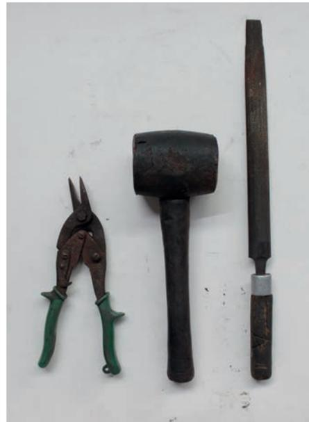
**HOJALATERÍA:** Tijera, mazo y lima empleados en el proceso de ensamblaje de las partes de los objetos.
