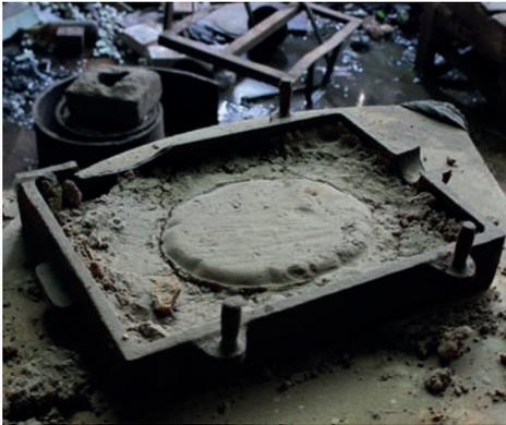
**FUNDICIÓN:** Parte de molde de arena empleado por Windsor Plaqué.
