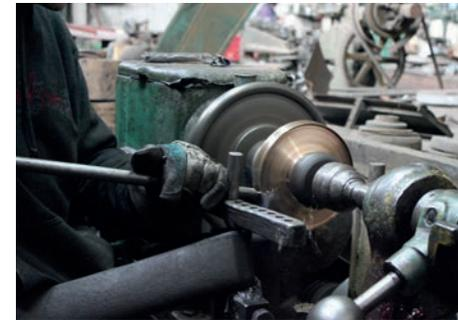
**REPUJADO:** Proceso de fabricación de pieza torneada.
