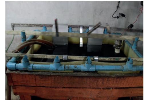
**GALVANIZADO:** Tanque con la solución de plata en el que se depositan los objetos que serán electroplateados.
