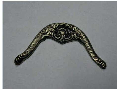
**FUNDICIÓN:** Asa fundida en un molde de arena.
